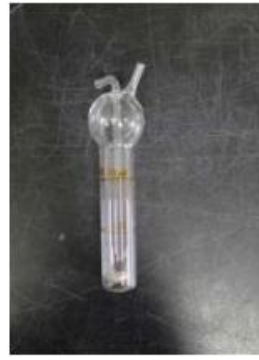
第1种：50ml 棕色 U 型多孔玻板吸收瓶 第2种：25ml 直型多孔玻板吸收瓶 第3种：50ml 直型多孔玻板吸收瓶 第4种：25ml 冲击式吸收瓶
